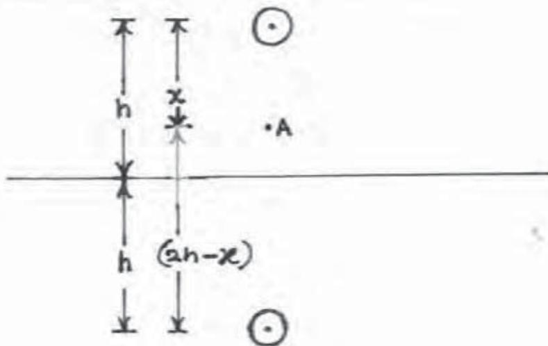
FIG.3. TO FIND  $V_{dc}$  IN TERMS OF  $\sigma$
