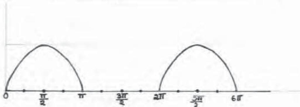
FIG.1. HALF WAVE RECTIFIED SINE WAVE
