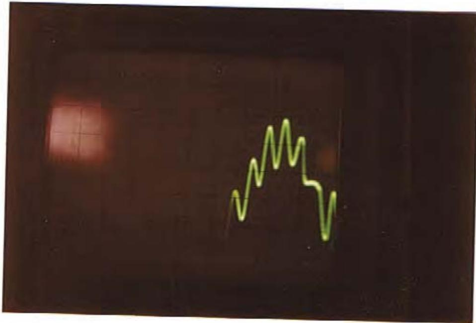
FIG.4. WAVEFORM FORM FOR DC CORONA
