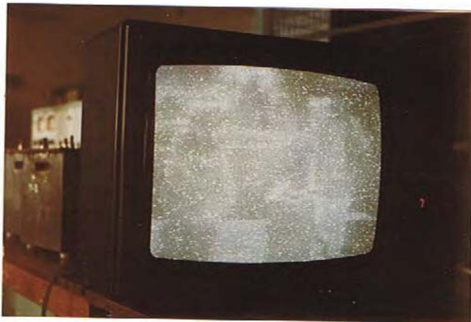
FIG.5. TV INTERFERENCE IN DC CORONA
