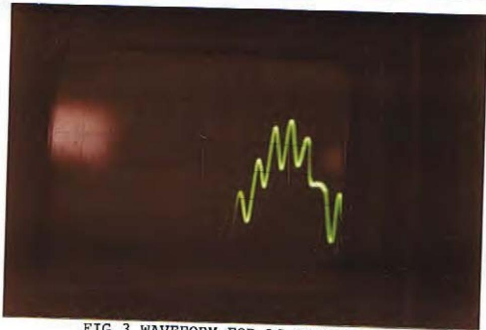
FIG.3 WAVEFORM FOR AC CORONA
