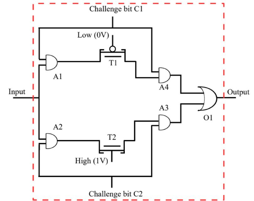
Fig. 3. Configuration Module
